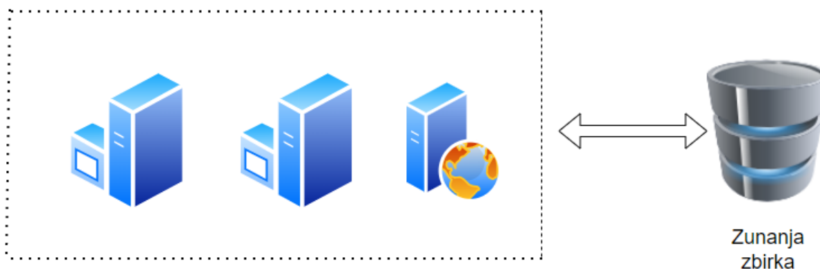
Slika 3: Srednja plast koristi vmesnike za morebitno integracijo z zunanjimi storitvami, pri čemer so lahko uporabljeni različni protokoli, največkrat pa gre za REST spletne klice.
